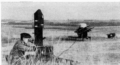
Рис. 5. Английская система ЗУРО «Сайтлайн» на огневой позиции (слева — пульт управления, в центре — стартовый агрегат, справа — источник электропитания).
